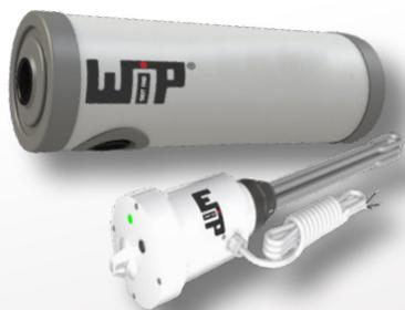
WIP® Zusatzheizmodul WZM dient zur Heizungsunterstützung für den Heizkessel oder für Wärmepumpen. Je nach Ausführung kann das Modul waagrecht oder senkrecht eingebaut werden. Der Betrieb des Moduls ist mit Wasser oder mit einem geeigneten Wasser/Glykolkemisch (max. 50%) möglich.
