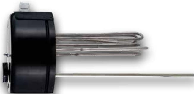
Spezialausführung zur Erwärmung von Wasser, CNF5-Rohrheizk. (Incoloy/Chrom-Nickel-Stahl) auf Flanschplatte isoliert aufgesetzt montiert, mit Schutzstrom-Ableitwiderstand, mattschwarze Schutzkappe, von außen einstellbarer Temperaturregler, allpoliger Sicherheits-Temperaturbegrenzer, Flanschdichtung.
